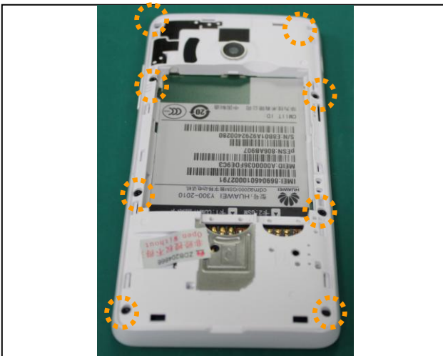
5. 拆除后壳上的 6 颗螺丝。
