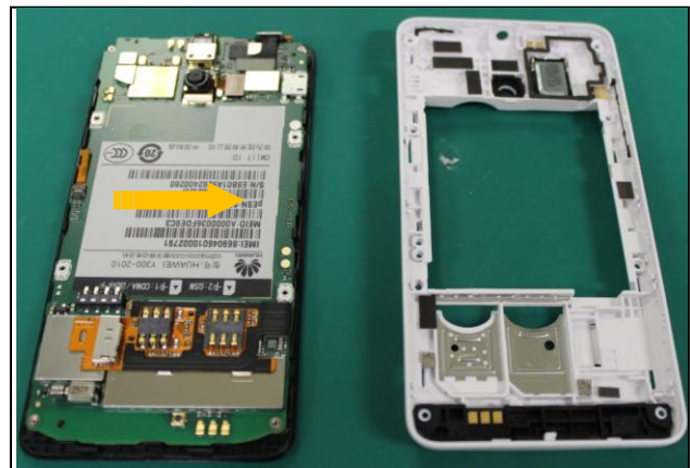
6. 用拆机拨片从上端右侧边角插入后将这个卡扣拆开
