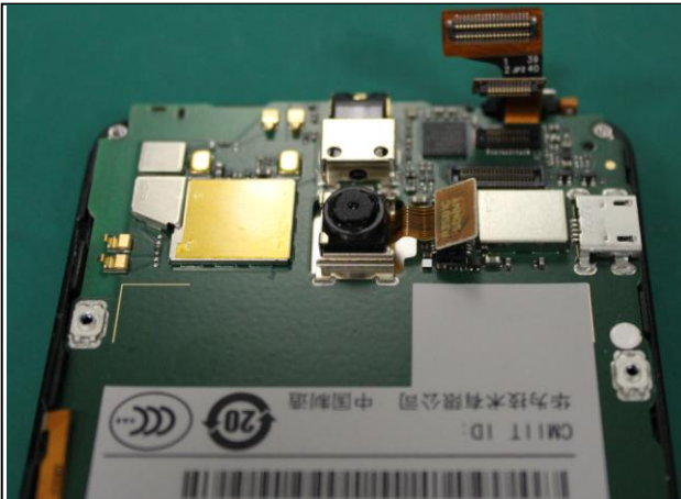
11. 松开触摸屏、LCD 及 CAMERA 的 BTB 线。
