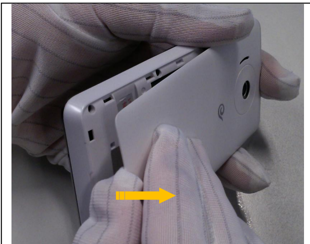
3. 拆电池盖：从上部抓手位置向后打开。
