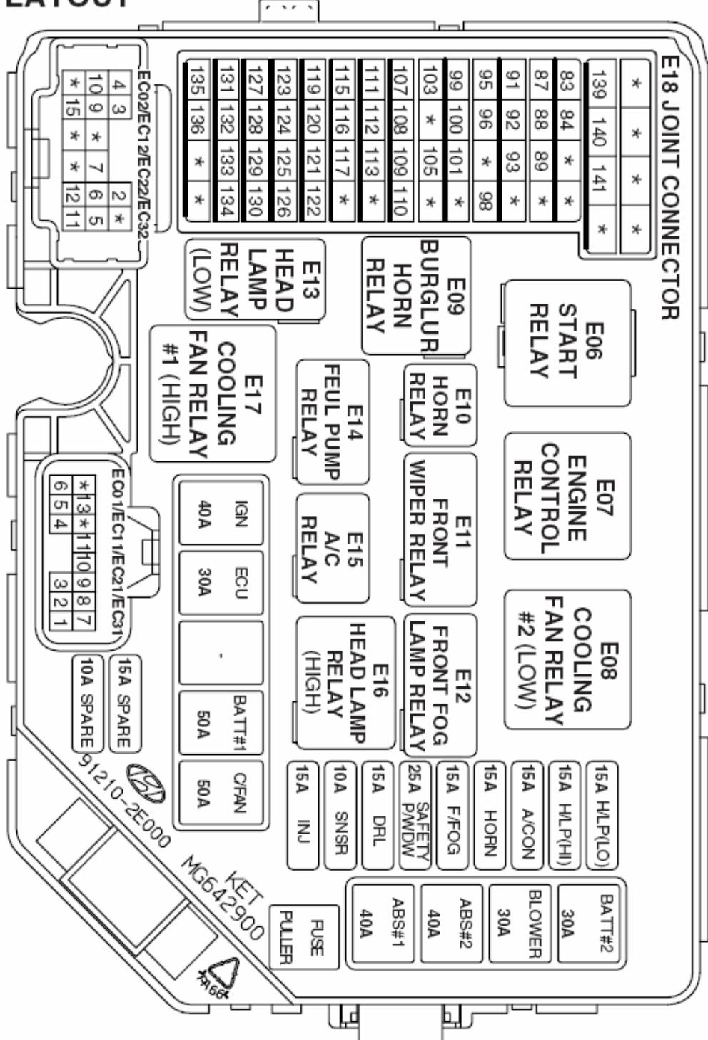
تصویر شماره ۲۳: برای دستیابی به مشخصات هر یک از فیوزها و رله های تصویر بالا به جدول شماره ۱۴ مراجعه کنید.
