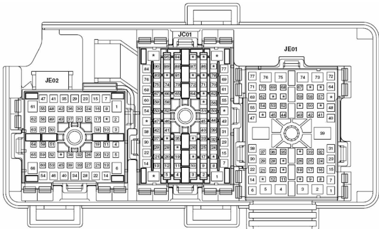
تصویر شماره ۱۵: زیر جعبه فیوز داخل محفظه موتور، اتصالات بصورت تصویر بالا است.
