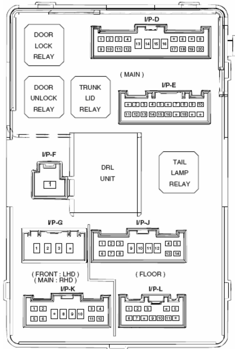
تصویر شماره ۱۳: نحوه اتصالات رله ها و اتصالات در زیر محل اتصال فیوزهای داخل اتاق
