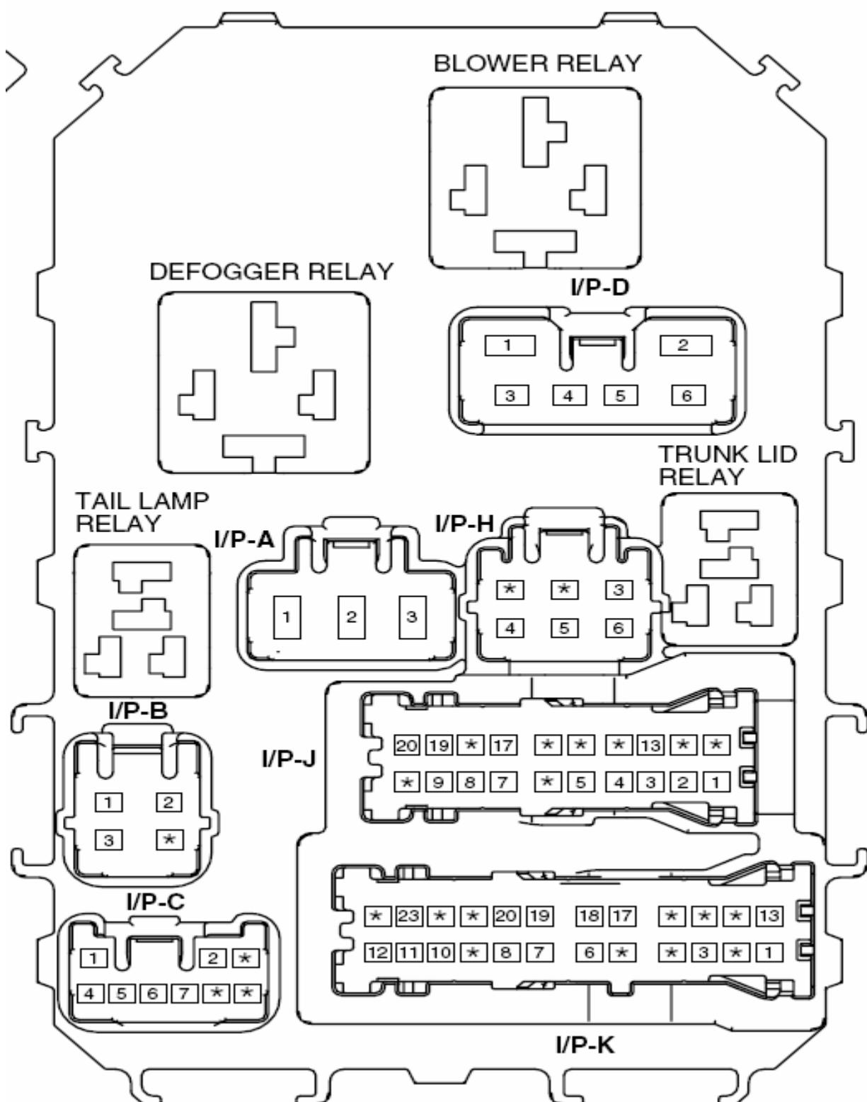
تصویر شماره ۷: نحوه اتصالات رله ها در زیر محل اتصال فیوزهای داخل اتاق.
