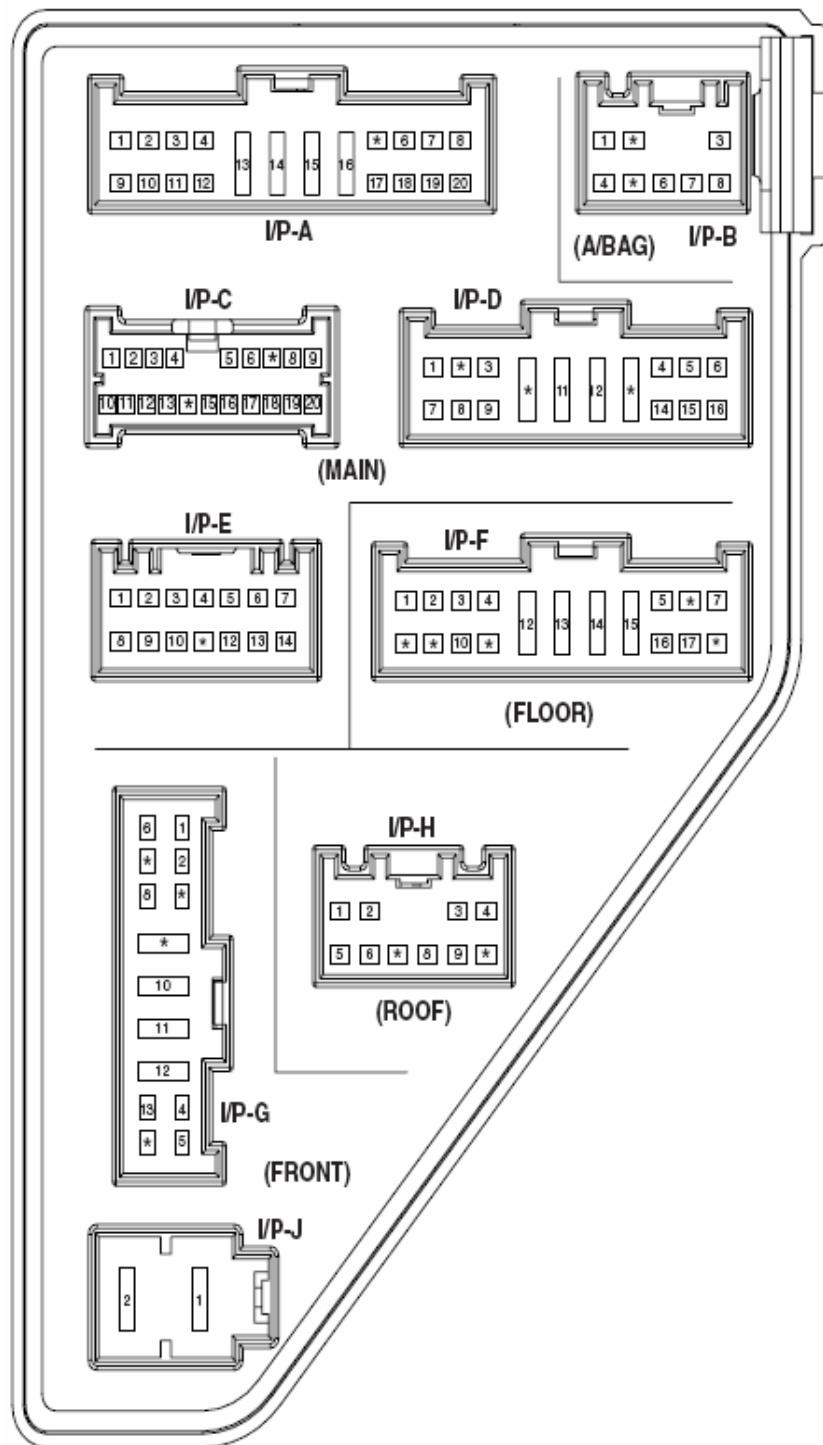
تصویر شماره ۲۲: نحوه اتصالات رله ها در زیر محل اتصال فیوزهای داخل اتاق همانند تصویر بالا می باشد.
