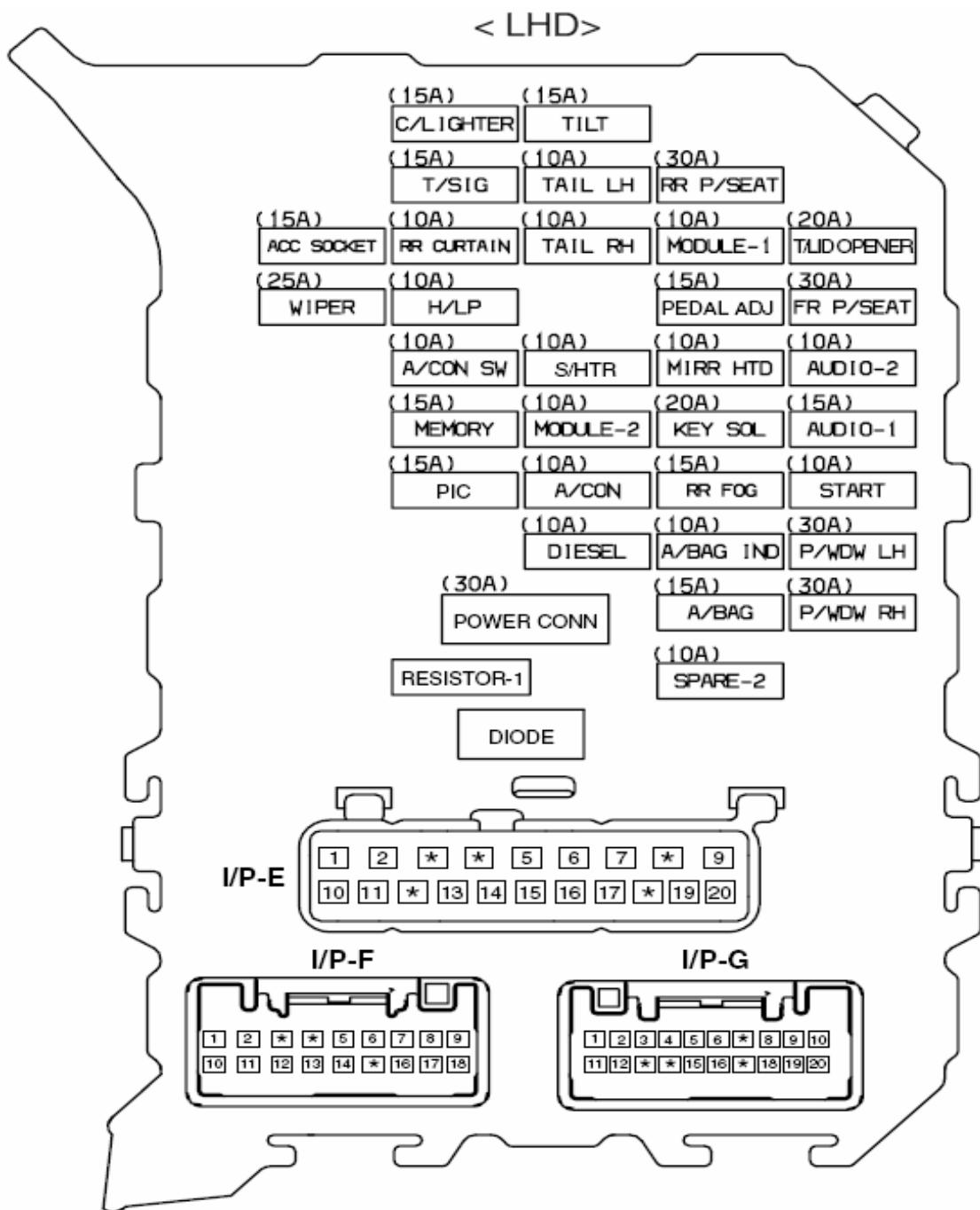
تصویر شماره ۶: برای خودرو های آزرا بی که فرمان آنها در سمت چپ قرار دارد، جعبه فیوز داخل اتاق آن مشابه شکل بالا است. برای دستیابی به مشخصات هر یک از فیوز های تصویر بالا به جدول شماره ۳ مراجعه کنید.
