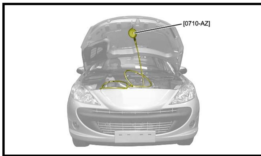
قلاب ابزار اندازه‌گیری [0710-AZ] را به بالای درب موتور متصل کنید.
