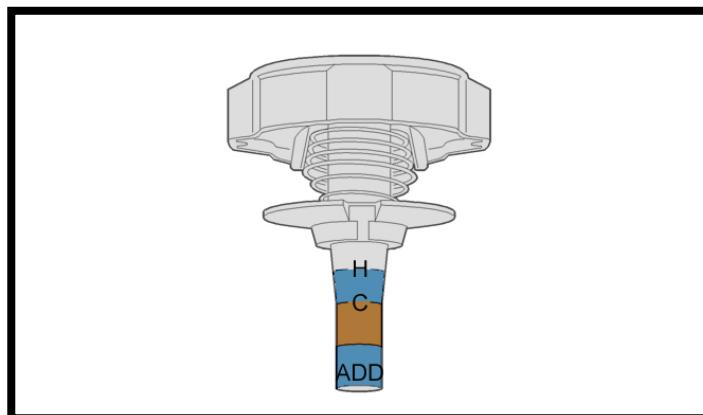
روغن پمپ هیدرولی را تا سطح Maximum سرریز نمایید:
