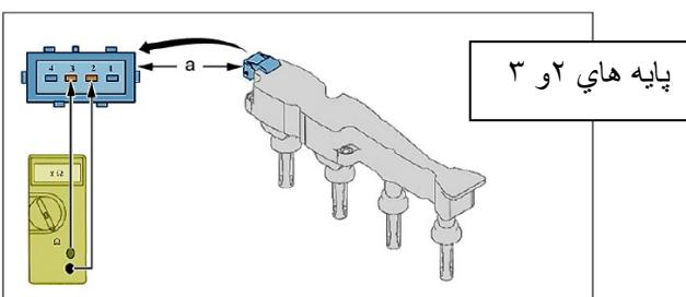
مقاومت سیم پیچ ثانویه موتور TU3
