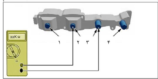
لازم به ذکر است که مقادیر جداول مربوط به مقاومت سیم پیچ ثانویه فقط برای پایه های نشان داده شده در تصاویر می باشد و پایه های دیگر می بایست نسبت به هم دارای مقاومت بینهایت باشند.
