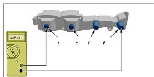
مقاومت سیم پیچ ثانویه موتور TU5
